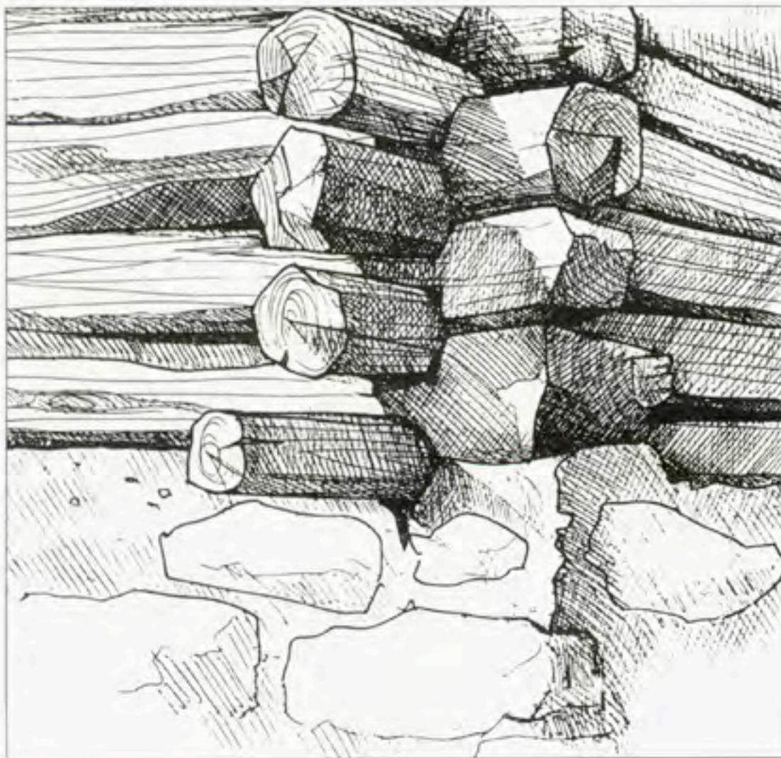
**Struttura a Blockbau.**
